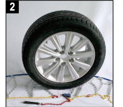
**2** Faire passer le câble flexible derrière la roue en partant du côté jaune, de gauche à droite.
