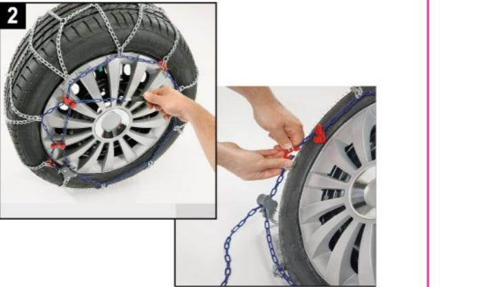
**Décrocher le tendeur en caoutchouc noir puis retirer également la chaîne du système autobloquant rouge.**
