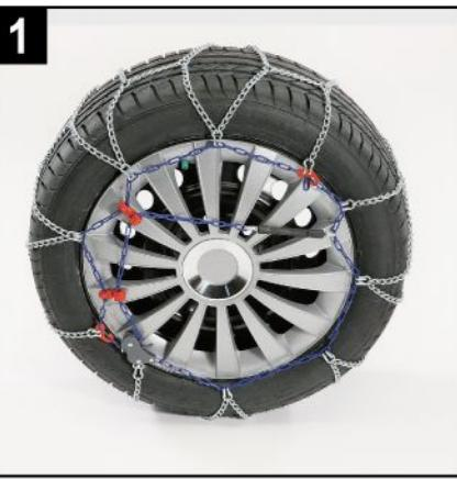
**Arrêter la voiture de façon à ce que le crocheton plat rouge soit tourné vers le haut (vers l'avant pour les voitures à traction avant).**
