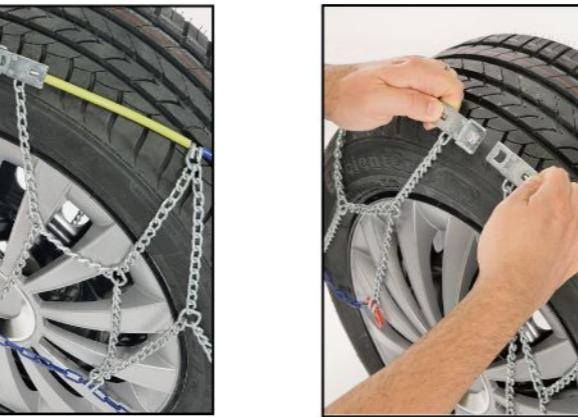
**Déplacer un peu le véhicule pour dégager la chaîne. (Pour les voitures à traction avant, il est conseillé de braquer les roues pour décrocher plus facilement le câble intérieur)**
